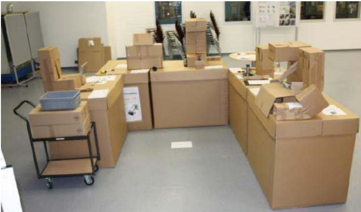
Abb. 1: Beispiel für Card-Board-Engineering in einer U-Shape Zelle
